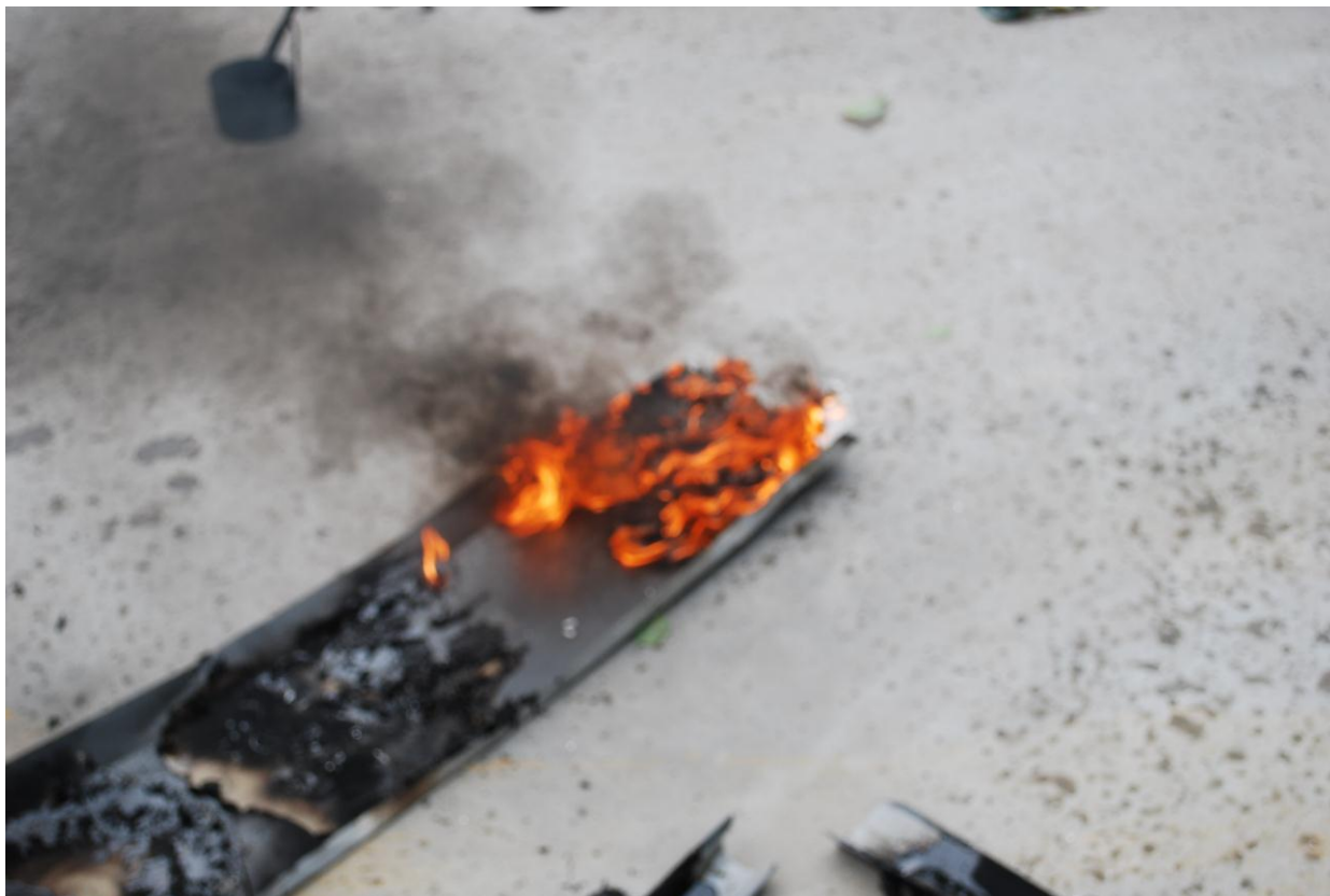
Bild 5. Branden efter ca 2 minuter, observera pölbränderna.
