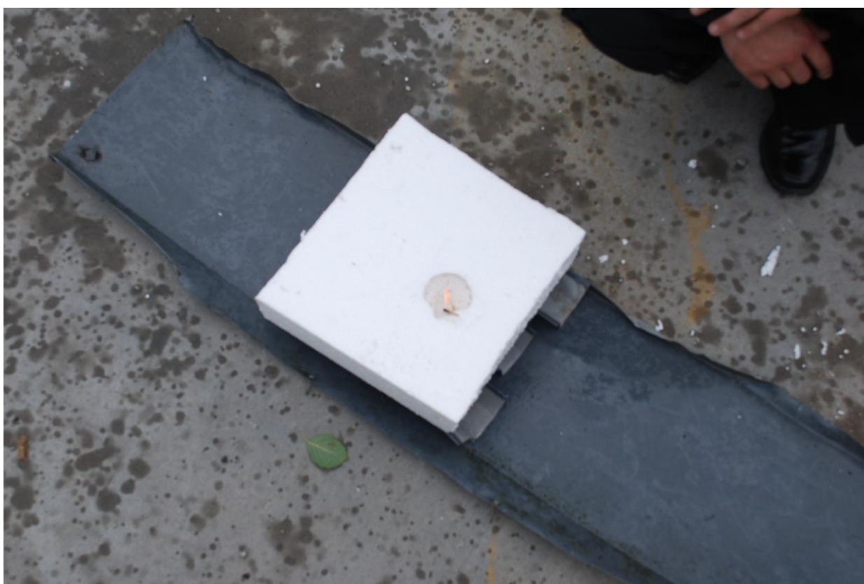
Bild 4. Brandprov, cellplastisolering, antänds med tändsticka.
